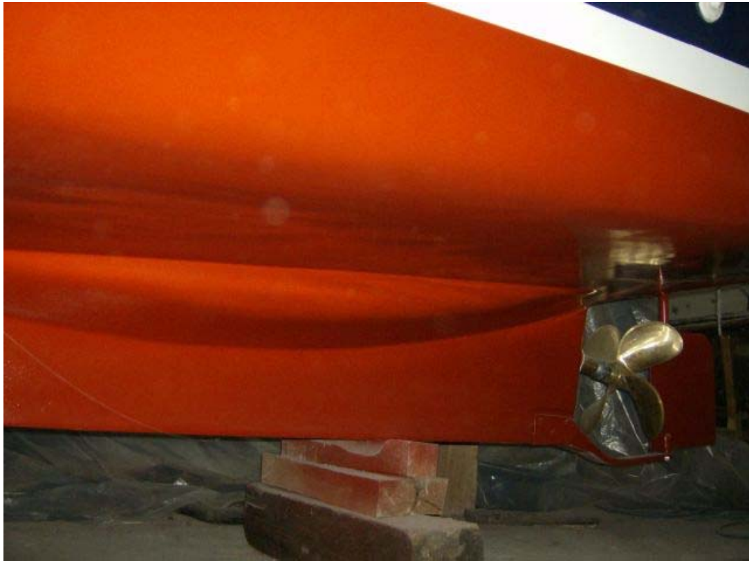
Resim-14: Teknenin omurgası hem pervaneyi korumakta hem de, teknenin yalpa hareketini önemli ölçüde azaltmaktadır. Gövde altındaki pabuç/hörgüç tasarımı ile motor normalden daha aşağıya bağlanabilmekte ve dolayısı ile teknenin ağırlık merkezide aşağıya çekilmektedir.
