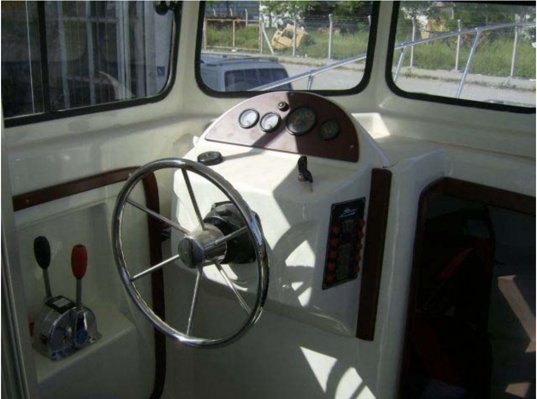
Resim-8: Kaptan köşkünden 360 derece kesintisiz görüş hattı olup, seyir hali ve çekek yerine yanaşma manevraları açısından önemli bir avantajdır. Kamara içi yükseklik 1.95 cm olup, rahatlıkla ayakta durulur. Ön-orta ve yan camlar hareketlidir. Direksiyon simidi hidrolik pompaya bağlıdır. Motor göstergeleri, kumada sandığının üstüne, elektrik paneli ise yan yüze monte edilmiştir.
