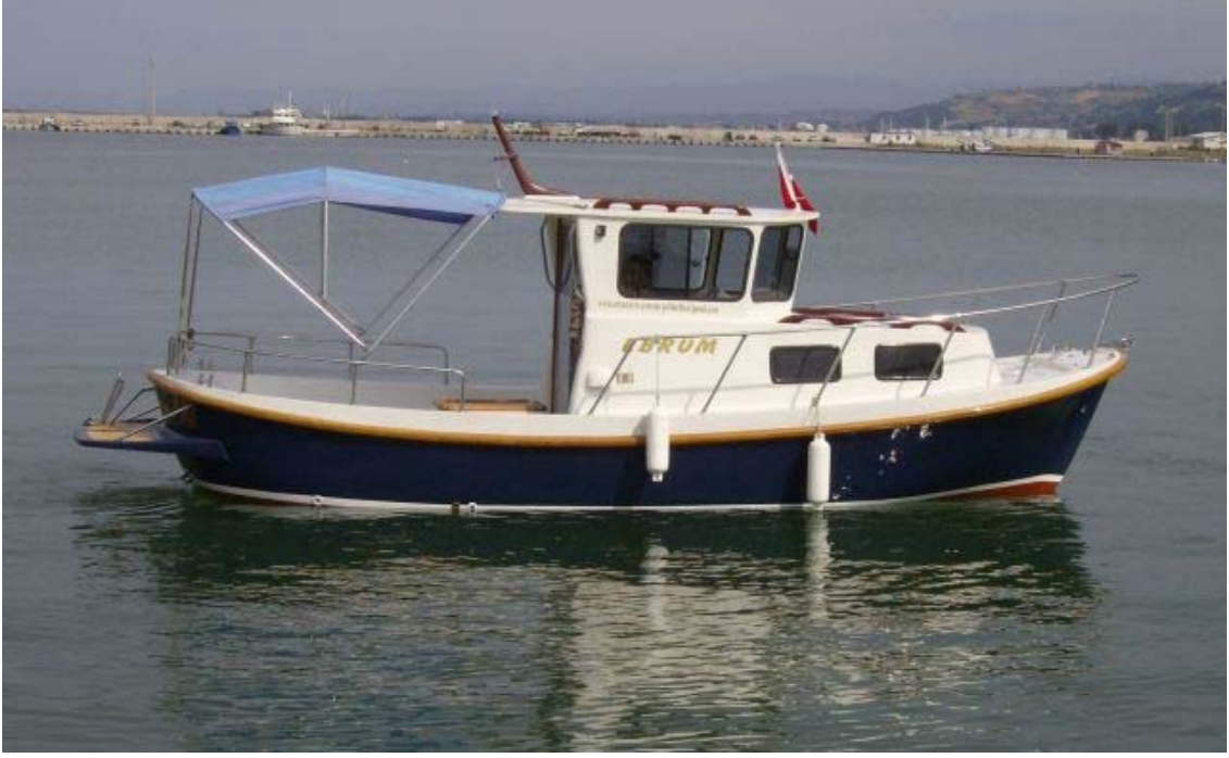
Resim-3: Seyir halinde güvenlik için gerekli olan korkuluklar tekneyi çepeçevre kuşatmıştır. Arka havuzluktaki açılır/kapanır tente de görülmektedir. Korkuluk ve tente ayakları, deniz suyuna dayanıklı paslanmaz 316 kalite kromdur.
