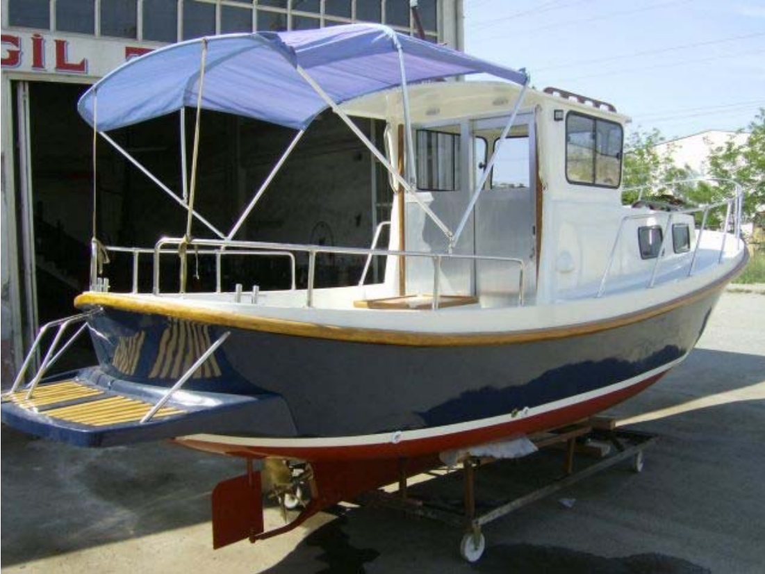
Resim-10: Teknenin karadayken arka-yandan görünümü. Kamara giriş kapısı biri sabit diğeri hareketlidir ve eloksallı alüminyum malzemeden imal edilmiştir.
