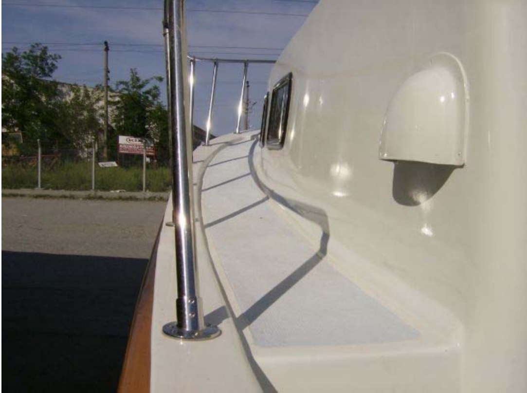
Resim-4: Küpeşte genişliği 25 cm olup, denizde hareket halinde bile baş üstüne güvenli geçişi sağlar. Motor hava girişleri kamaranın sağında (ve solunda) bulunmaktadır.
