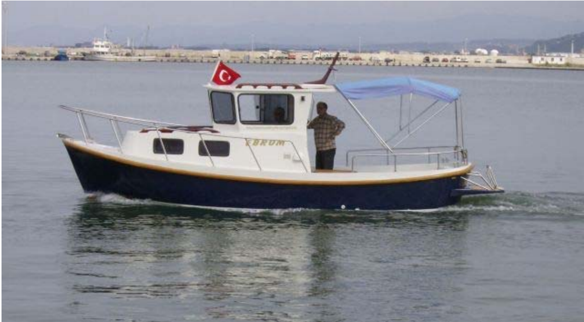
Resim-2: Kaptan 360 derece görüş açısına sahiptir. Sert ve yağmurlu havalarda, en yakın limana kuru bir şekilde seyir imkan veren tam kapalı yapısı, öne eğimli cam profili ile yağmur ve sepkende azami görüş imkanı, güneşli havalarda ise ışığın yansıma ve kırılmalarla gözü etkilemesini önleyecek şekilde tasarlanmıştır. Teknenin sualtı gövdesinin sahip olduğu hidrodinamik yapı, küçük motor gücü gereksinimi ve dolayısı ile ekonomik seyir olarak kullanıcıya döner.
